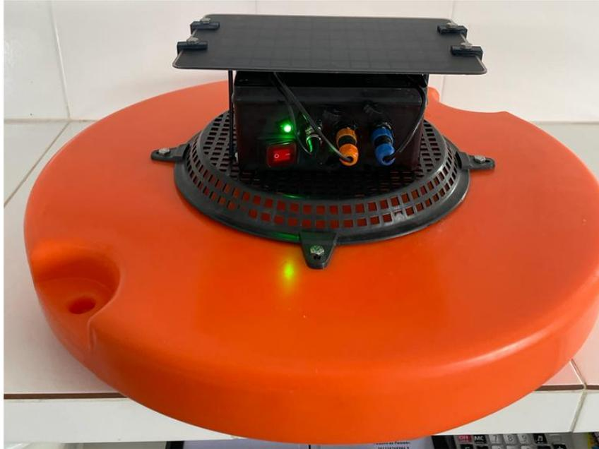
Figura 11 – Sistema IoT para sensoriamento da qualidade da água.
