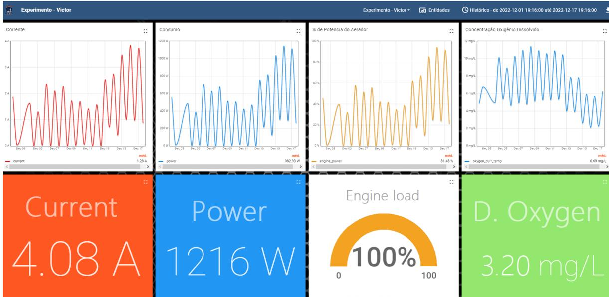
Figura 13 – Dashboard da plataforma IoT.
