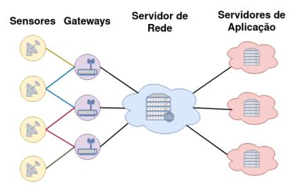
Figura 3 – Exemplo de arquitetura LoRaWAN.
