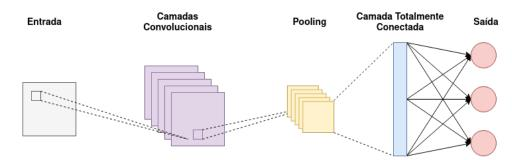
Figura 6 – Exemplo de uma arquitetura de CNN.
