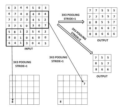
Figura 7 – Exemplo de *Max Pooling* com diferentes valores de *Stride*. Fonte: (AGGARWAL, 2018).
