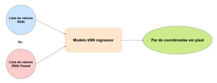
Figura 19 – Fluxograma do processo de estimativa do modelo kNN.
