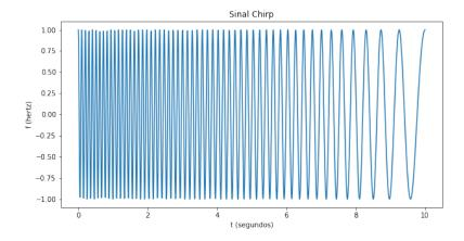
Figura 2 – Representação gráfica de um exemplo de sinal de Chirp.
