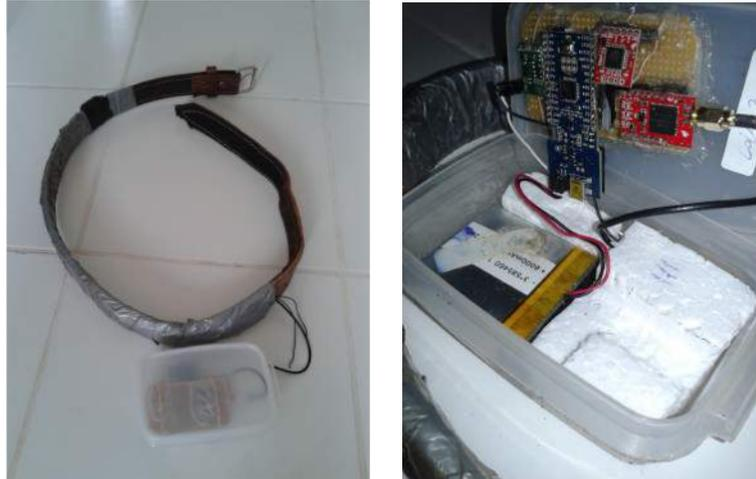
Figura 4 – Coleira equipada com a placa junto com os sensores
